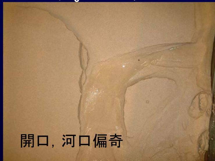
$\eta=0.035\text{m}, H_0=0.06\text{m}, Q=250\text{ml/s}$
