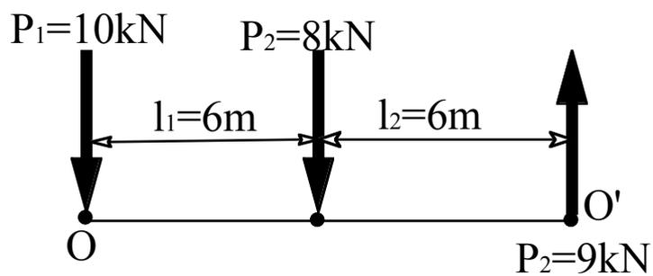
3. 1 点に作用していない数力の合力  $\mathbf{R}$  とその作用位置を求め、図示せよ.
