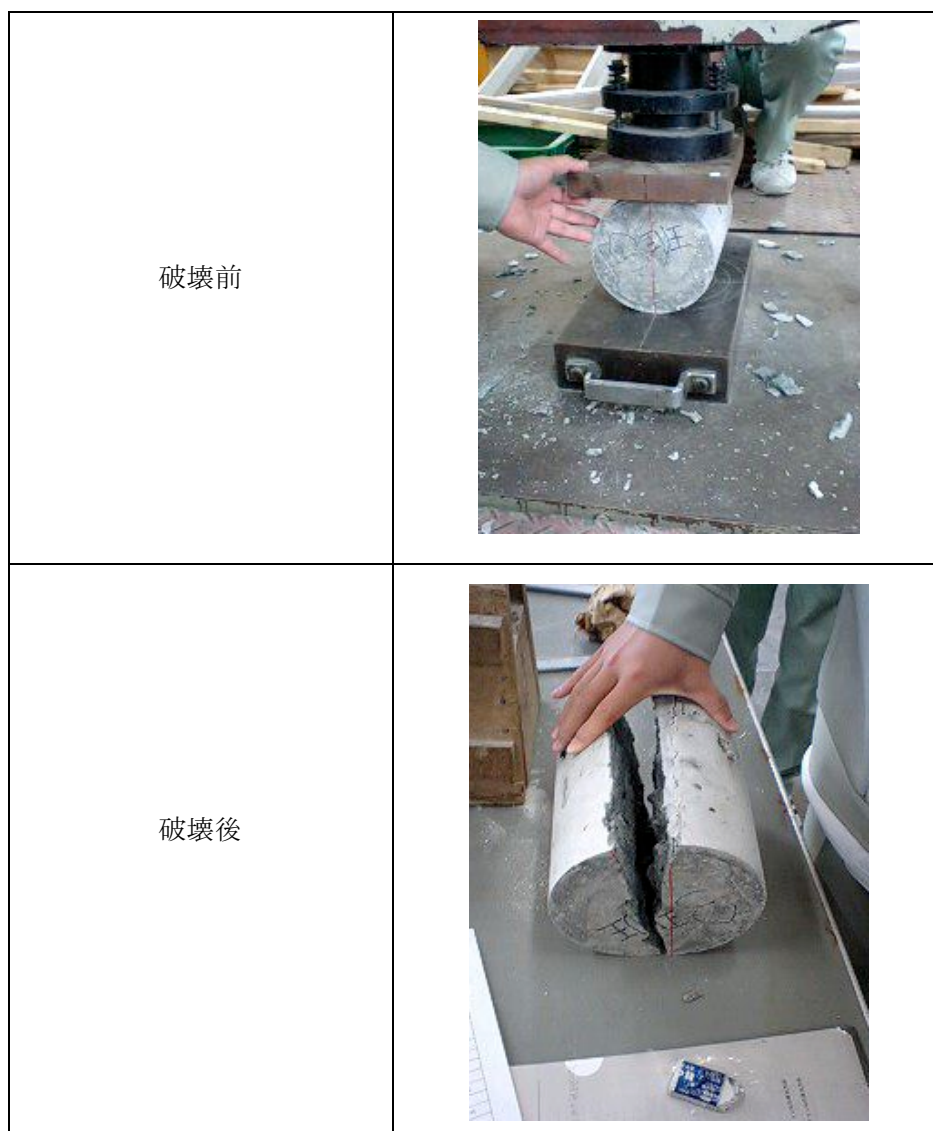
図-? 試験状況およびコンクリートの破壊状況
